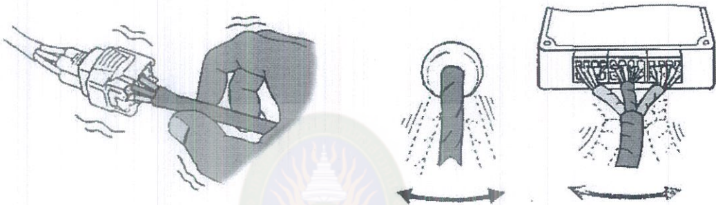
รูปที่ 1.69 การตรวจสอบการ หลวมของชุดสายไฟ
