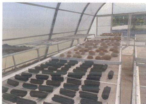
ภาพที่ 3.58 นำถ่านเข้าโรงอบพลังงานแสงอาทิตย์ 1-2 วันที่อุณหภูมิตั้งไว้ที่ 60 องศาเซลเซียส
