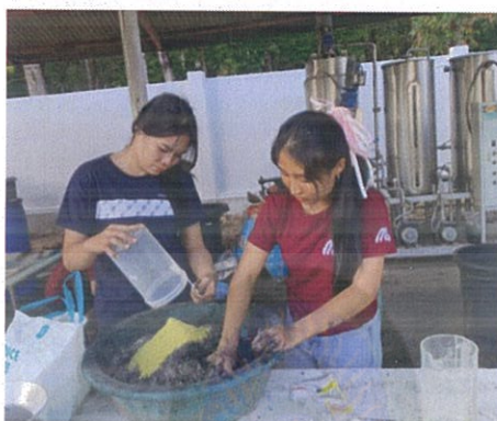
ภาพที่ 3.43 นำผงถ่านกะละมะพร้าว : กาวแป้งเปียกเข้าเครื่องผสมถ่าน
