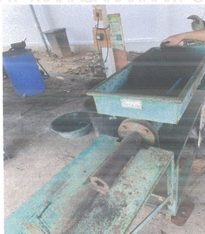
ภาพที่ 3.12 เครื่องอัดแท่งถ่าน แบบไฟฟ้า 5 แรงม้า
