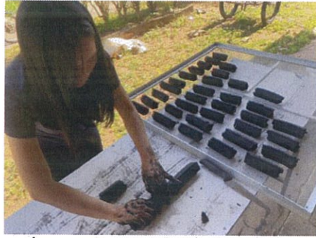
ภาพที่ 3.55 ลักษณะถ่านที่ได้จากการอัดแท่ง
