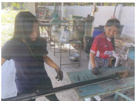
ภาพที่ 3.54 นำส่วนผสมที่ได้ขึ้นรูปถ่านอัดแท่งด้วยเครื่องอัดแท่งแบบไฟฟ้า
