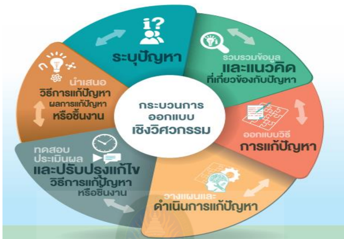
ภาพที่ 2.1 กระบวนกรออกแบเชิงวิศวกรรมสถาบันการสอนวิทยาศาสตร์และเทคโนโลยี
