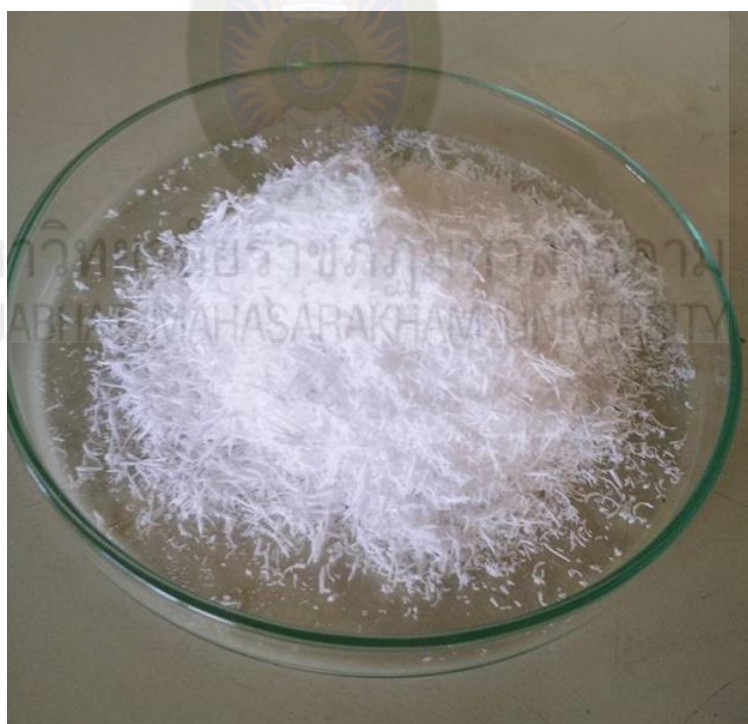
ภาพที่ ค.4 ซิลิกาจากแกลบที่ผ่านการเผาที่ 900 องศาเซลเซียส เป็นเวลา 6 ชั่วโมง
