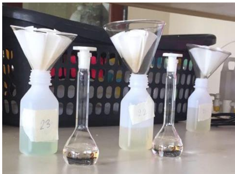
ภาพที่ ค.17 กระบวนการกรองและเจือจางสารตัวอย่างก่อนทดสอบหาโลหะด้วย AAS
