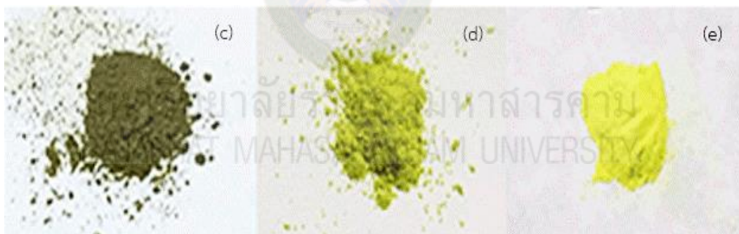
ภาพที่ 4.36 วัสดุผสมสารเชิงซ้อนของโลหะแทรนซิชัน Co(II), Ni(II) และ Zn(II) กับ 8hq ในวัสดุรูพรุนซิลิกาโดยวิธีการบดรวม: Co(8hq) 2 @MCM (c), Ni(8hq) 2 @MCM (d) และ Zn(8hq) 2 @MCM (e)
