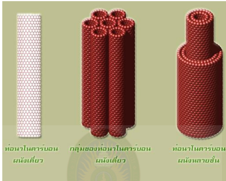
ภาพที่ 2.8 ท่อนาโนคาร์บอนผนังชั้นเดียวและท่อนาโนคาร์บอนผนังหลายชั้น ที่มา: http://www.il.mahidol.ac.th/e-media/nano/Page/Unit3-8.html
