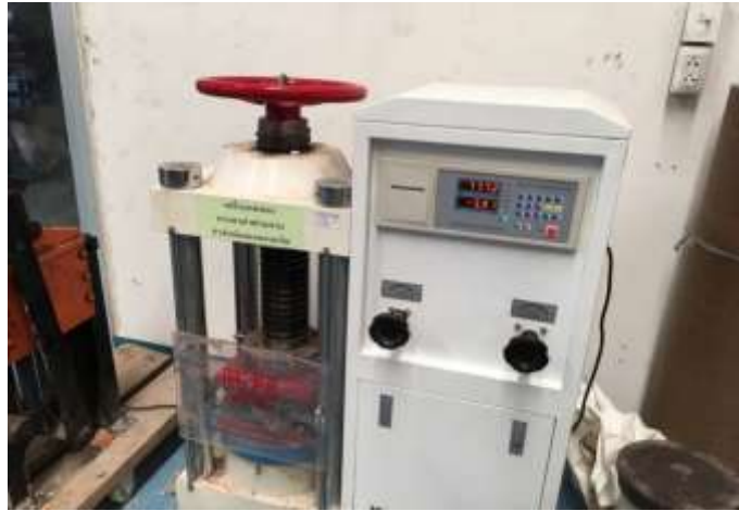
ภาพที่ 3.1 เครื่องมือทดสอบกำลังอัดคอนกรีตคอนกรีต
