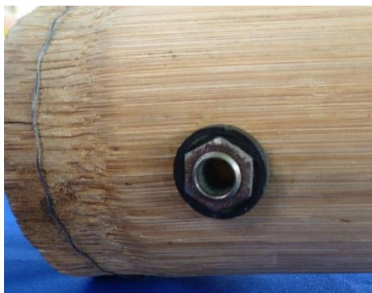
ภาพประกอบที่ 4.76 ช่องต่อสัญญาณเสียงของซอบังไม้ไฟ
