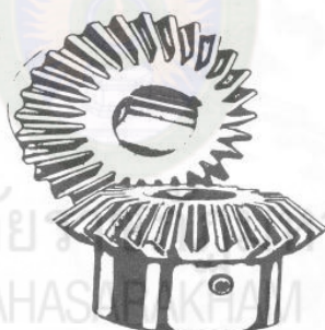
ภาพที่ 2.10 เฟืองดอกจอกที่เพลาทำมุมฉากกัน (จำเนียร ศิลปะวานิช, 2538)
