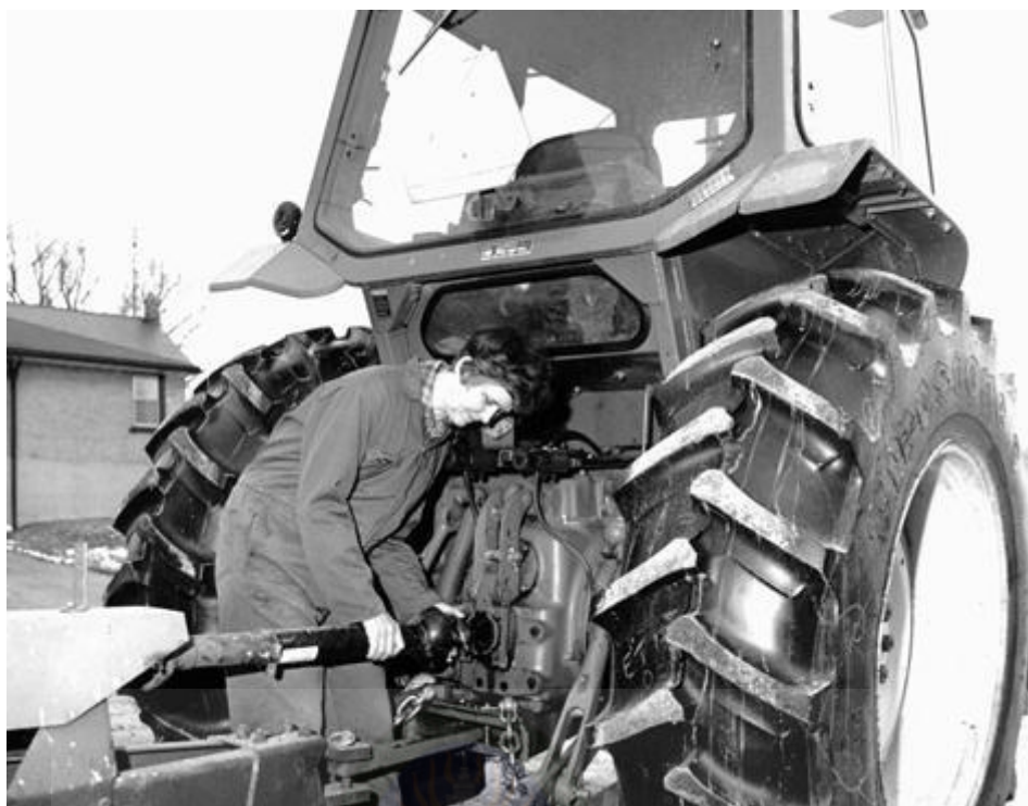
ภาพที่ 2.6 ระบบส่งกำลังที่นิยมใช้กับรถแทรกเตอร์ (ประณต กุลประสูติ, 2544)
