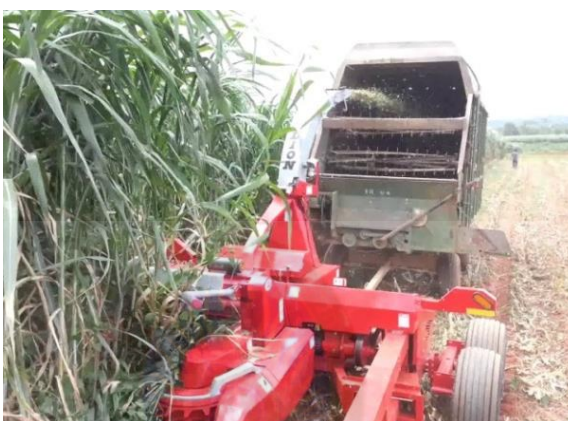
ภาพที่ 2.3 แสดงเครื่องตัดหญ้าเนเปียร์ (บุญเจิต กาญจน, 2552)
