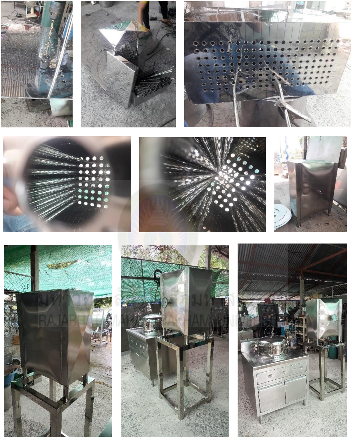
ภาพที่ ก.2 การสร้างชุดควบแน่น (Condenser)
