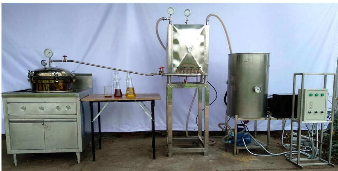
ภาพที่ 13 ภาพอุปกรณ์ระบบการผลิตน้ำมันเชื้อเพลิงโดยกระบวนการไพโรไลซิสจากขยะพลาสติก ชุมชน
