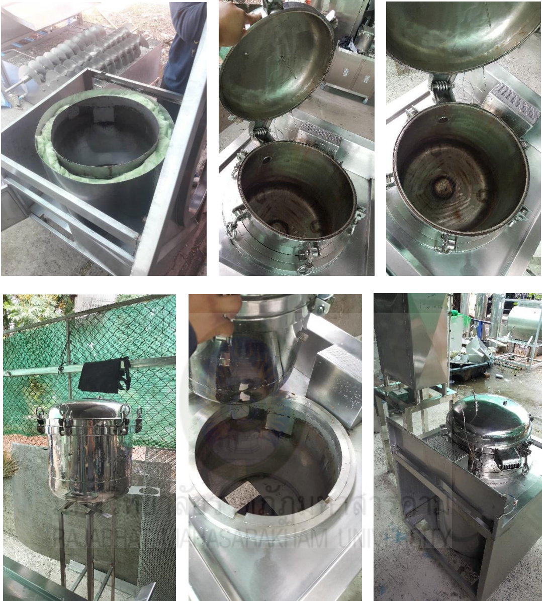
ภาพที่ ก.1 การสร้างชุดเตาปฏิกรณ์ (Reactor)
