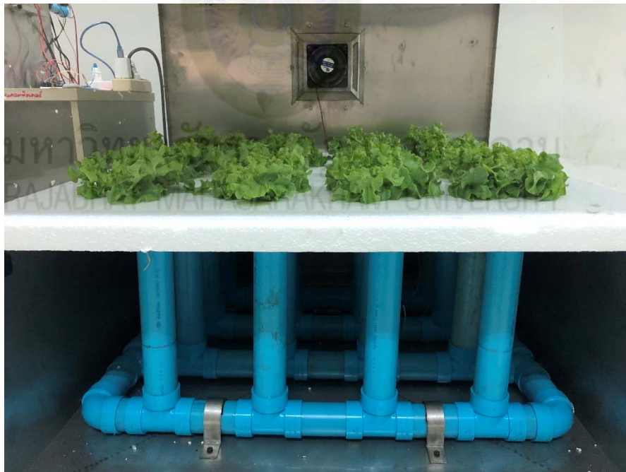
ภาพที่ ข-6 ส่วนให้ความเย็นและท่อเก็บพักน้ำ
