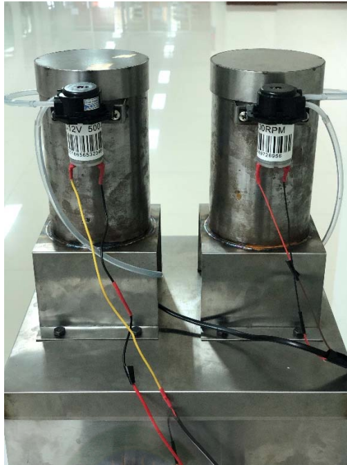
ภาพที่ ข-9 ถังเก็บสารละลายธาตุอาหาร A และสารละลายธาตุอาหาร B
