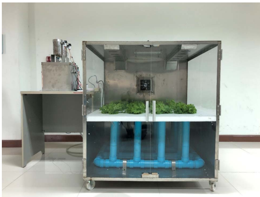
ภาพที่ 3.1 ตู้ปลูกพืชไฮโดรโปนิกส์แบบอัตโนมัติ
