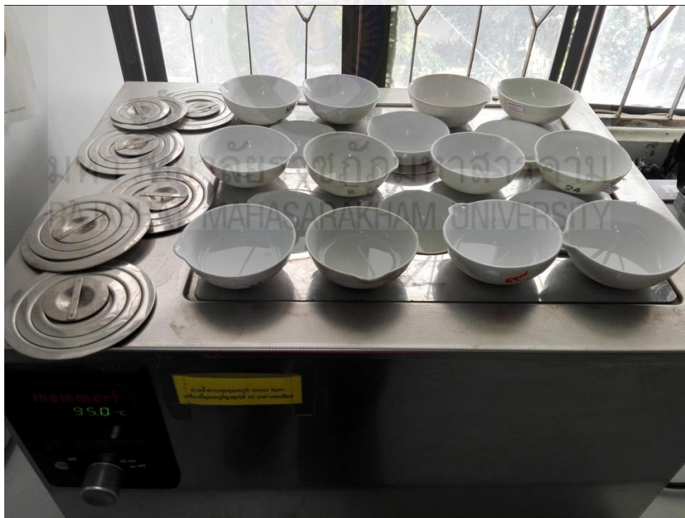
ภาพที่ ค-22 วิเคราะห์ปริมาณของแข็งที่ละลายน้ำด้วยเครื่อง Water Bath
