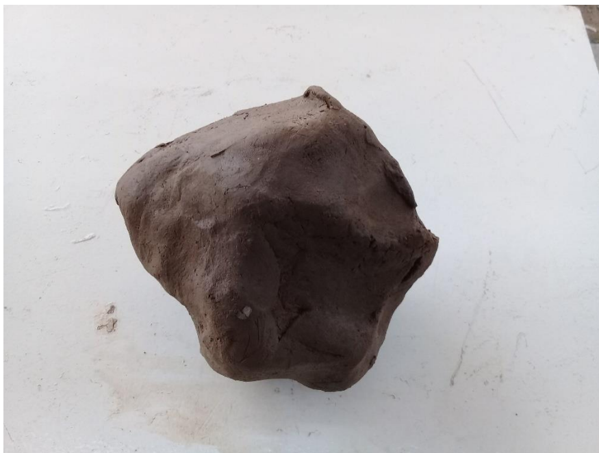
ภาพที่ 3.16 ดินที่ผ่านการนวดแล้วพร้อมนำไปใช้งาน
