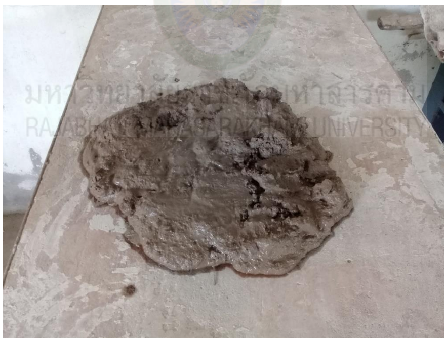
ภาพที่ 3.4 โตะกระอะดิน พื้นผิวหน้าทำจากปูนปลาสเตอร์เพื่อให้ดูดน้ำจากเนื้อดิน
