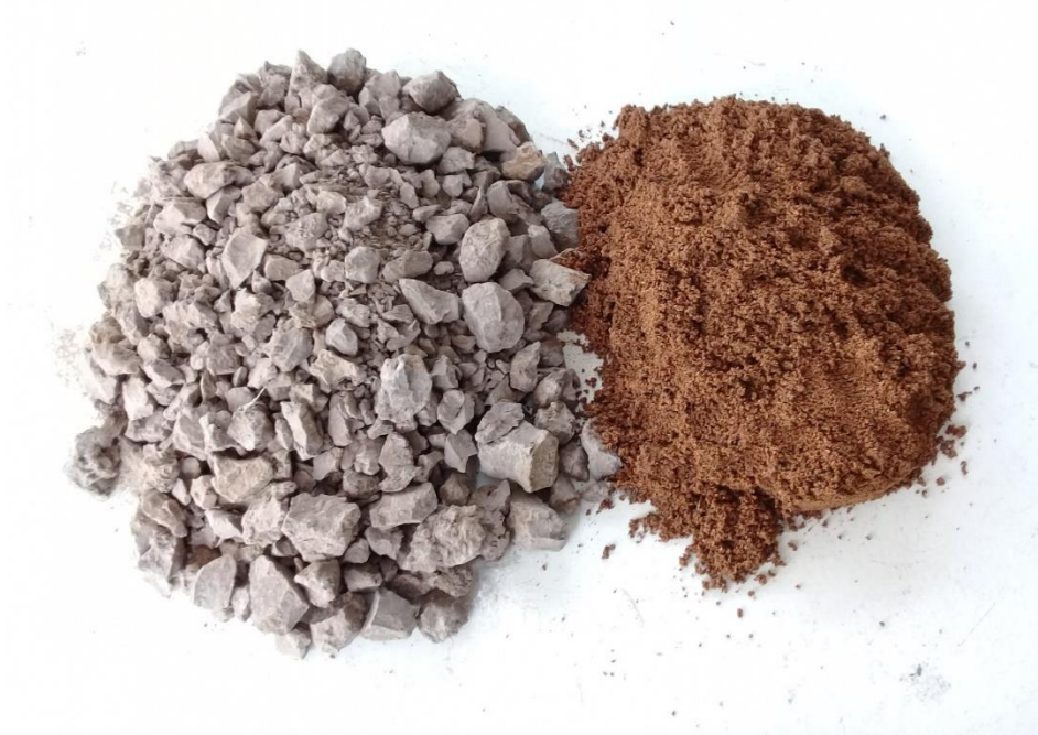
ภาพที่ 3.12 เตรียมนำดิน และดินเชื่อมผสมกันในอัตราส่วน 60/40
