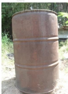
รูปที่ 2.10 เตาเผาถ่านถัง 200 ลิตร (แบบตั้ง)
