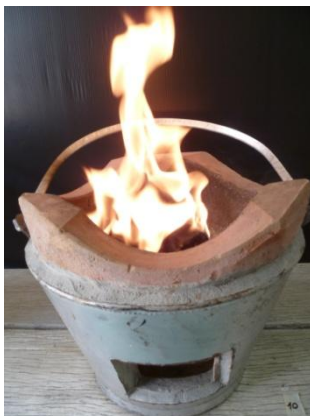
รูปที่ ก-19 การทดสอบคุณภาพของถ่านอัดแท่งด้วยการจุดไฟในเตา
