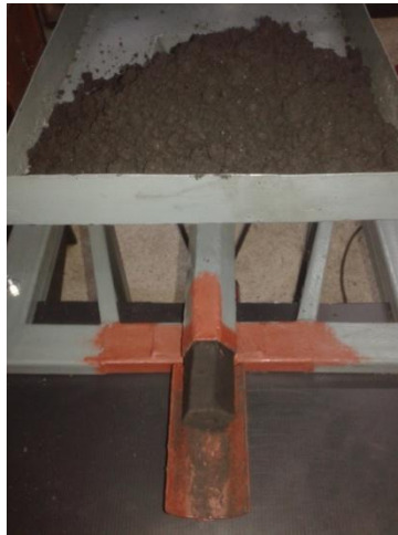
รูปที่ 3.4 การอัดแท่งถ่านด้วยเครื่องอัดเย็น
