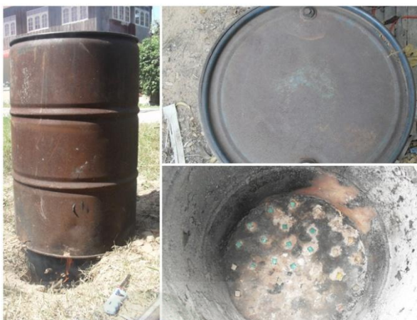
รูปที่ 2.11 ส่วนประกอบของเตาเผาถ่าน 200 ลิตร (แบบตั้ง)
