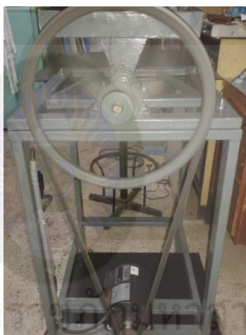
รูปที่ ก-14 เครื่องอัดถ่านแบบเย็น ที่ผลิตขึ้นเอง
