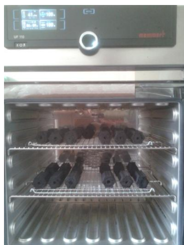
รูปที่ ก-18 การอบถ่านด้วยเครื่องอบลมร้อน
