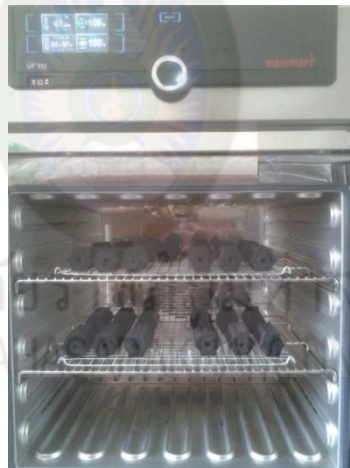
รูปที่ 3.5 การอบถ่านด้วยเครื่องอบลมร้อน
