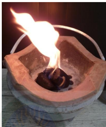
รูปที่ 3.8 การทดสอบคุณภาพของถ่านอัดแท่งด้วยการจุดไฟในเตา
