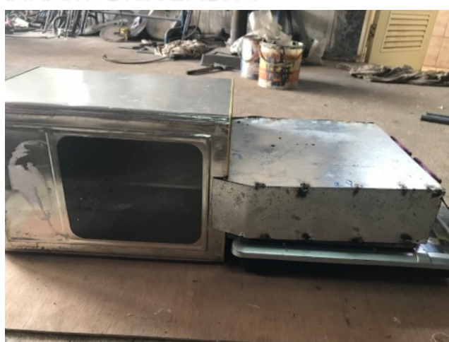
ภาพที่ 4.3 การประกอบแหล่งกำเนิดความร้อนแบบเหนี่ยวนำแม่เหล็กไฟฟ้าและห้องอบแห้งเข้าด้วยกัน
