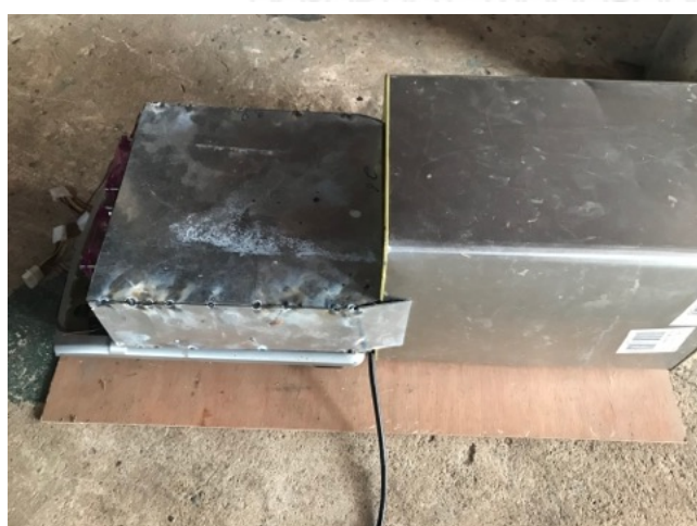
ภาพที่ 4.3 การประกอบแหล่งกำเนิดความร้อนแบบเหนี่ยวนำแม่เหล็กไฟฟ้าและห้องอบแห้งเข้าด้วยกัน
