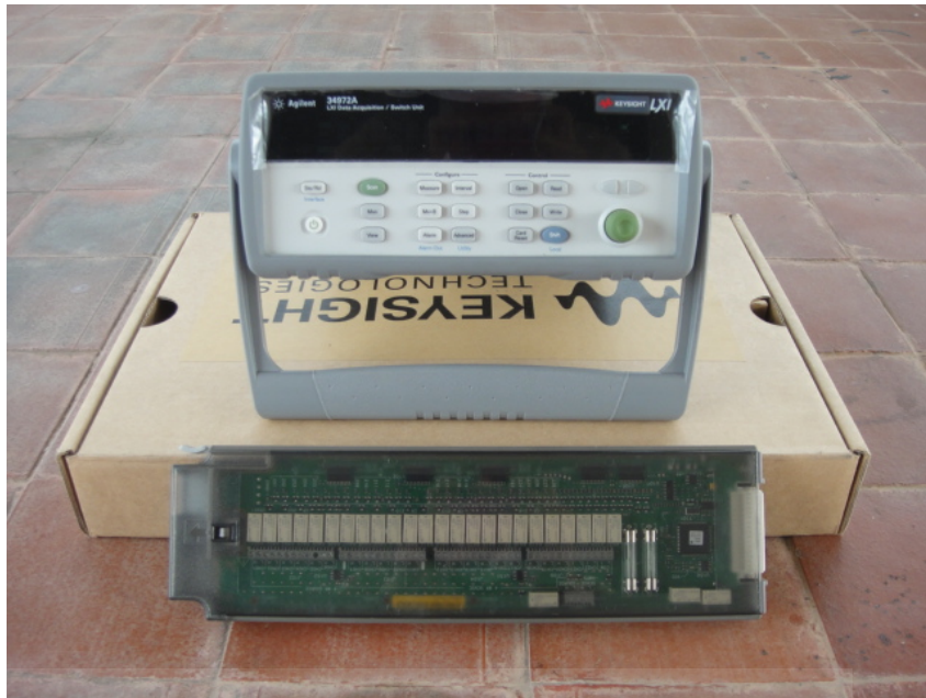
ภาพที่ จ-5 เครื่องบันทึกข้อมูลอุณหภูมิ (data logger)
