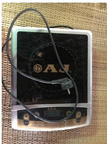
ภาพที่ 4.1 เตาแม่เหล็กไฟฟ้าขนาด 2,000 วัตต์
