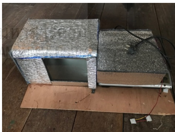
ภาพที่ 4.5 เครื่องอบแห้งลมร้อนด้วยวิธีความร้อนเหนี่ยวนำแม่เหล็กไฟฟ้า
