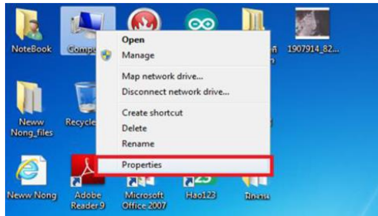
รูปที่ 3.11 การตรวจสอบการเชื่อมต่อกันระหว่างบอร์ดควบคุมกับคอมพิวเตอร์เมื่อต้องการเช็คพอร์ต USB Arduino ต่อกับพอร์ตหรือไม่
