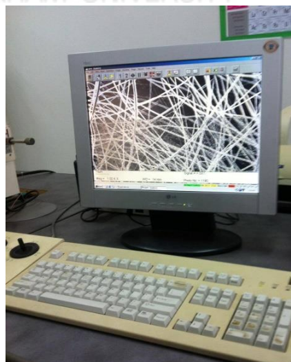
รูปที่ 3.17 วิเคราะห์เส้นใยด้วยกล้องจุลทรรศน์อิเล็กตรอนแบบส่องกราด
