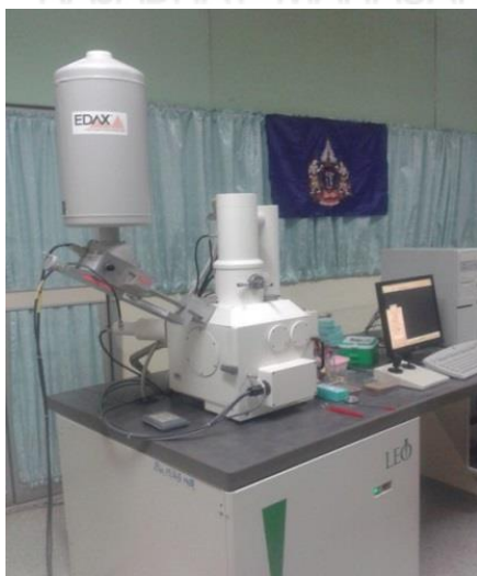
รูปที่ 3.17 วิเคราะห์เส้นใยด้วยกล้องจุลทรรศน์อิเล็กตรอนแบบส่องกราด
