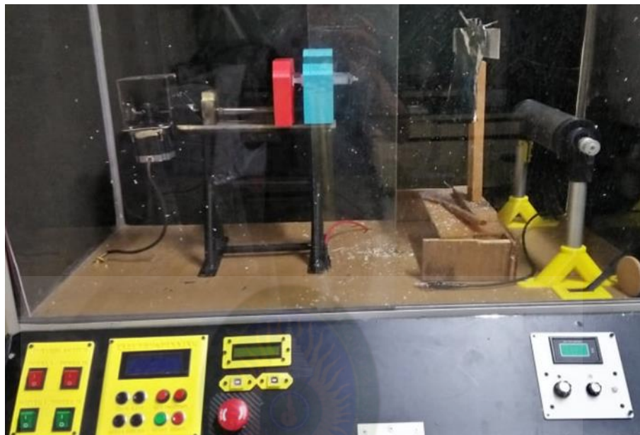
รูปที่ 3.5 ลักษณะระบบสังเคราะห์เส้นใยด้วยเทคนิคอิเล็กทรอนิกส์พินนิง มหาวิทยาลัยราชภัฏมหาสารคาม ADUAT RAJABHAKHAI UNIVERSITY
