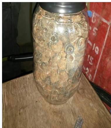
รูปที่ ข-14 การกลับสภาพของเฟอร์ริกไฮ ดรอกไซด์เมื่อเปิดฝาทิ้งไว้
