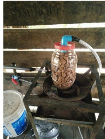
รูปที่ ข-10 ตักด้วยชุดตักเฟอร์ริกไฮดร ออกไซด์
