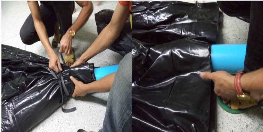
รูปที่ 3.25 มัดประกอบถุงหมักพีวีซีเข้ากับท่อพีวีซี
