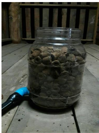
รูปที่ ข-13 การเปลี่ยนสีของเฟอร์ริกไฮดรอกไซด์ หลังดูดซับ H_2S
