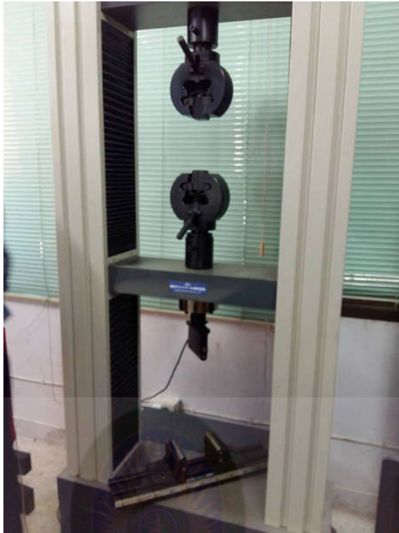
ภาพที่ ข-7 เครื่องทดสอบสมบัติเชิงกล UTM. รุ่น WDW-100D
