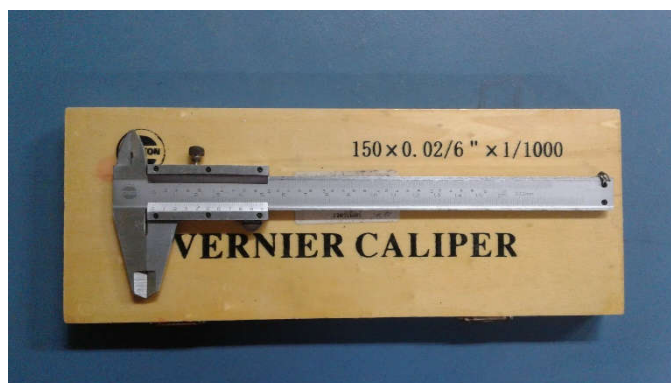
ภาพที่ ข-1 เวอร์เนีย Vernier Caliper ความละเอียด 0.02 mm
