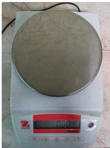
ภาพที่ ข-3 เครื่องชั่งดิจิตอล ทศนิยม 2 ตำแหน่ง
