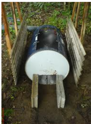
รูปที่ 2.9 เต้าเผาถ่านถ้ำ 200 ลิตร (แบบนอน) ที่มา (โศทร รอดคงที่, 2552)
