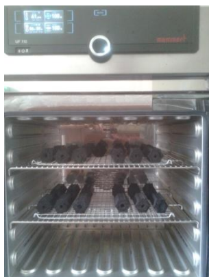
รูปที่ 3.5 อบถ่านอัดแท่งด้วยเครื่องอบลมร้อน
