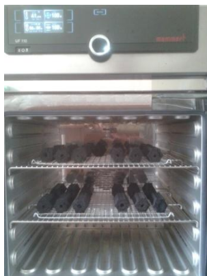
รูปที่ ข-7 อบถ่านอัดแท่งด้วยเครื่องอบลมร้อน
