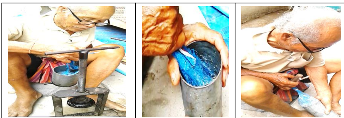
1. คลายแกนหมันเพื่อนำกล่องขากออกมา 2. ขยับถุงขากให้หลวม 3. ดึงถุงขากออกมาจากกล่อง
