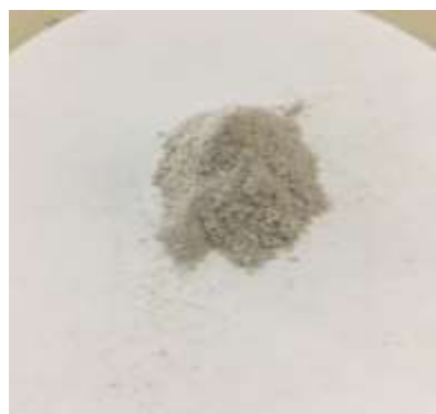
ภาพที่ ข.6 วัสดุผสม TiO 2 /MMT มีลักษณะสีน้ำตาลอ่อน
