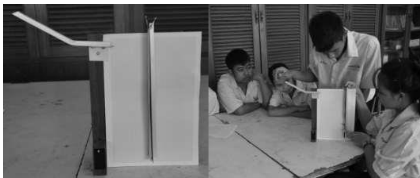
ก. ติดกระดาษคาร์บอนและกระดาษขาว ข. วางรางอะลูมิเนียมในแนวระดับและ เช้ากับ เป้าโลหะแล้วเกี่ยวกับเป็นไม้ ติดกระดาษกราฟ บนเป็นไม้
