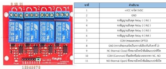
ภาพที่ 2.7 ภาพและตารางแสดงขาที่ใช้ในการเชื่อมต่อของ Relay Module 4 Channels
