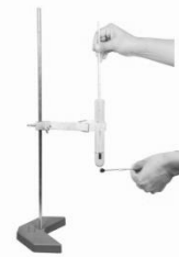
ต้มน้ำกลั่นด้วยความ ร้อนจากเมล็ดถั่วลิสง แห้ง
