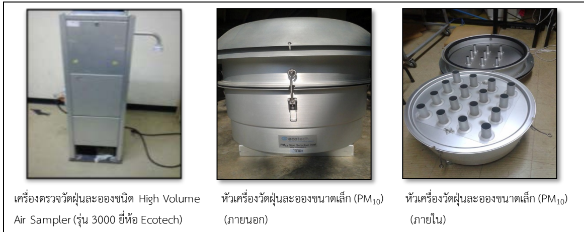
ภาพ ข-1 อุปกรณ์ส่วนประกอบของเครื่องตรวจวัดฝุ่นละอองชนิด High Volume Air Sampler (รุ่น 3000 ยี่ห้อ Ecotech)
