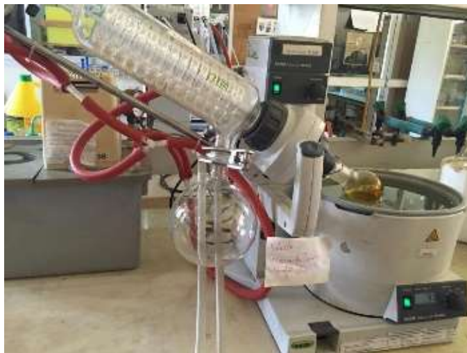
ภาพที่ ค-3 เครื่อง Rotary evaporator (รุ่น RVCHT)
