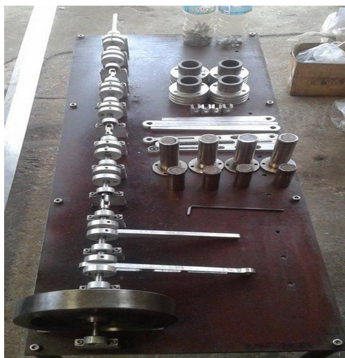
รูปที่ ข.2 ส่วนประกอบของเครื่องยนต์สเตอร์ลิงขนาดเล็ก
