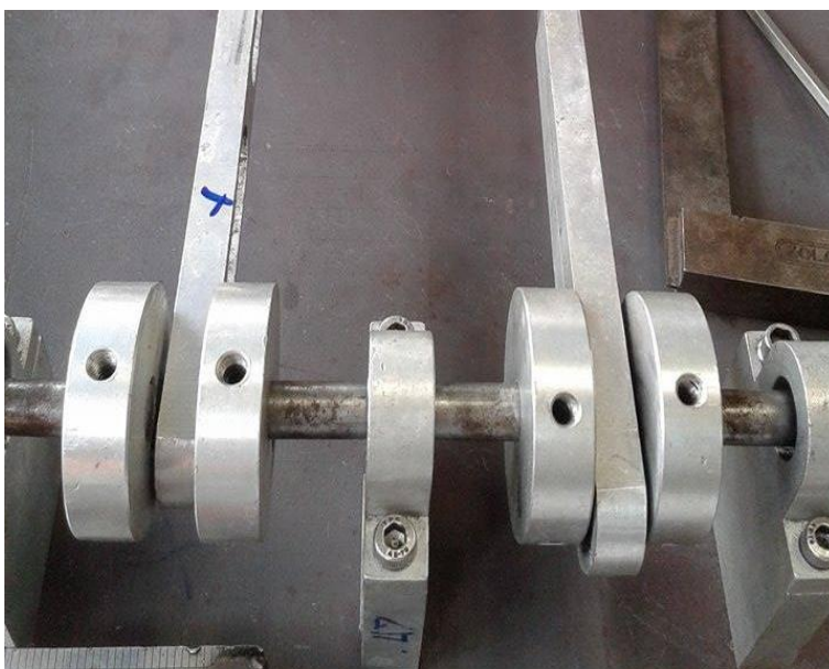
รูปที่ ข.4 ประกอบชุดข้อเหวี่ยงและคั่นชักเข้ากับแกนเพลา
