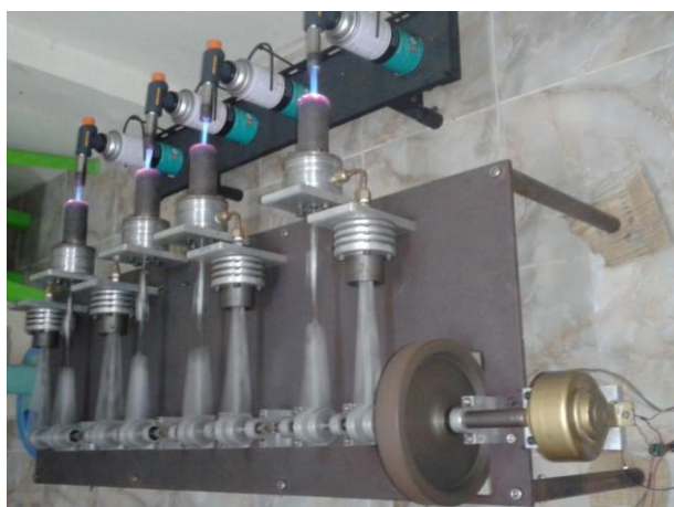
รูปที่ ข.9 การทดลองเครื่องยนต์สเตอร์ลิงขนาดเล็ก
