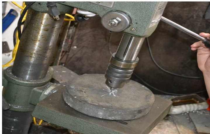
รูปที่ 3.4 หาดำแหน่งศูนย์กลางของล้อช่วยแรง
