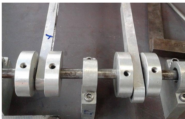
รูปที่ 3.10 ประกอบชุดข้อเหวี่ยงและคั่นชักเข้ากับแกนเพลลา
