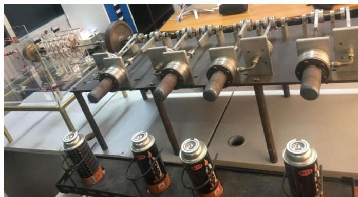
รูปที่ 3.15 เครื่องยนต์สเตอร์ลิงที่เสร็จสมบูรณ์
