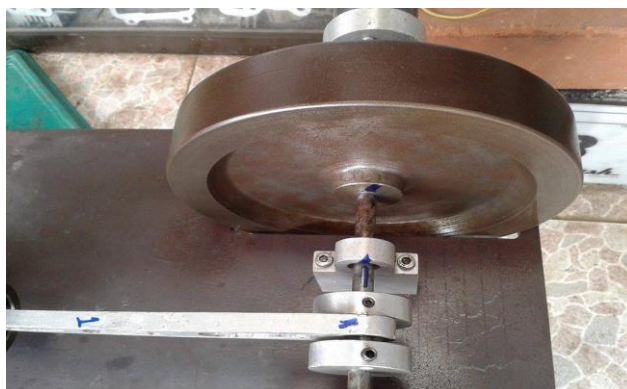
รูปที่ 3.9 ประกอบล้อช่วยแรงเข้ากับแกนเพลลา
