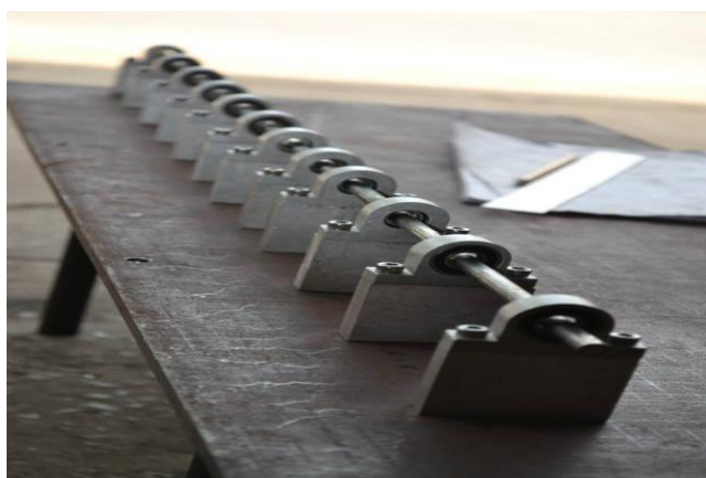
รูปที่ 3.8 ทำการประกอบตุ๊กตาเข้ากับฐานเครื่องยนต์สเตอร์ลิง
