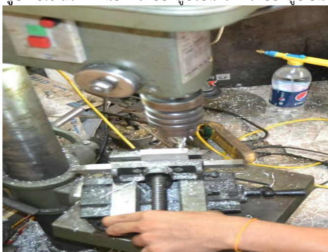
รูปที่ 3.6 สร้างแผ่นยึดกระบอกสูบร้อนและกระบอกสูบเย็น
