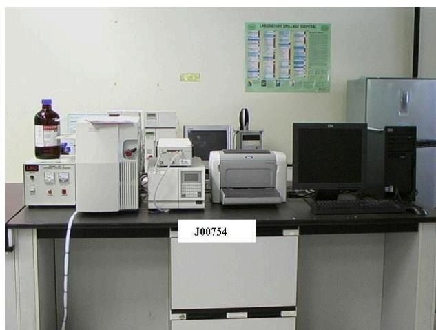
รูปที่ ก (3) เครื่อง Gel Permeation Chromatography (GPC) Model
