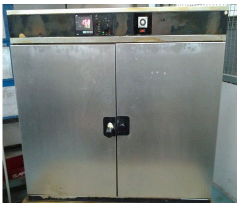
รูปที่ ก (5) ตู้อบให้ความร้อน (Hot air oven)
