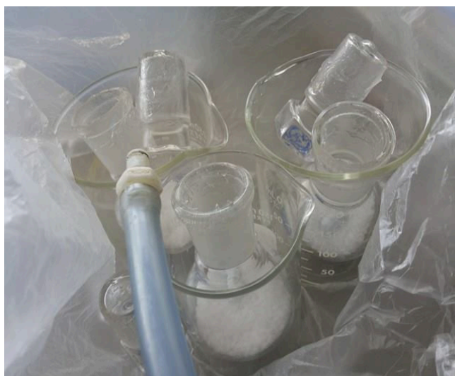
รูปที่ ข (4) ใช้แก๊สไนโตรเจนไล่ความชื้นเป็นเวลา 5 นาทีปิดฝาขวดก้นกลมโดยใช้ Silicone High Vacuum Grease
