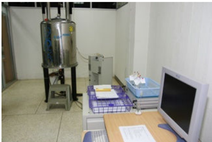
รูปที่ ก (2) เครื่อง Nuclear Magnetic Resonance Spectroscopy (NMR)
