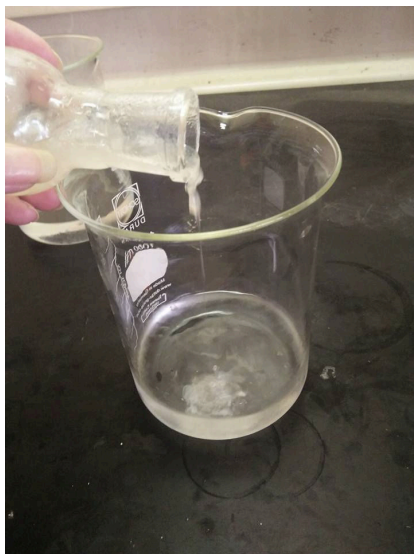
รูปที่ ข (8) จากนั้นนำไปตกตะกอนด้วยเมทานอล
