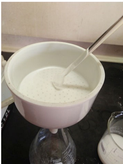
รูปที่ ข (9) กรองด้วยเครื่องกรองสุญญากาศ
