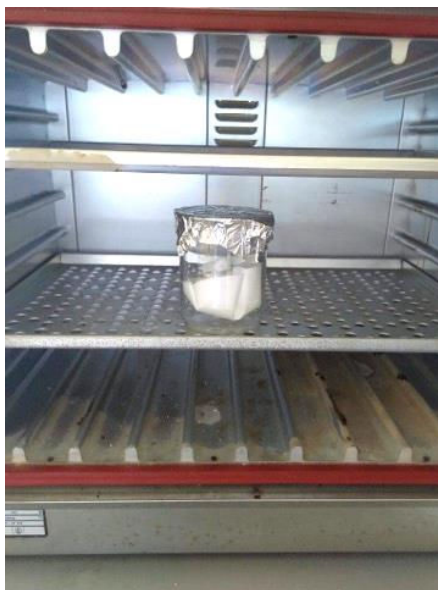
รูปที่ ข (10) สารที่กรองได้ใส่ปีกเกอร์ปิดด้วยอะลูมิเนียมฟอยล์เจาะรูเล็กๆนำไปอบเป็นเวลา12ชั่วโมงหรือจนสารแห้งที่อุณหภูมิ 45 องศาเซลเซียสนำไปชั่งน้ำหนัก
