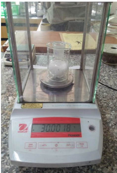
รูปที่ ข (3) ชั่ง PLA และ PBATใส่ลงในขวดก้นกลมและเติมตัวเร่งปฏิกิริยา \text{Sn}(\text{Oct})_2
