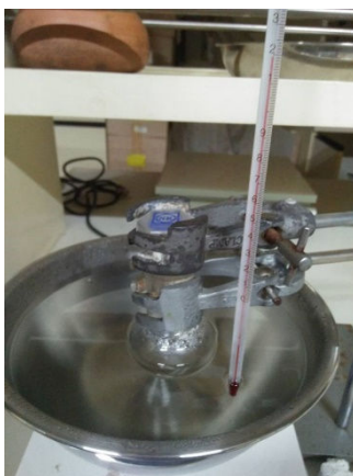
รูปที่ ข (5) นำขวดกั้นกลมไปจุ่มลงในน้ำมันซิลิโคน(Silicone oil) (Hotplate and magnetic stirrer) เวลา 4 และ 8 ชั่วโมง
