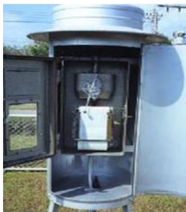
ภาพที่ 2.23 เครื่องวัดฝนแบบลูกลอย (Float Recording Gage)
