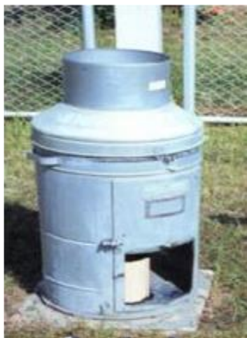
ภาพที่ 2.22 เครื่องวัดฝนแบบชั่งน้ำหนัก (Weighting-type gauge)
