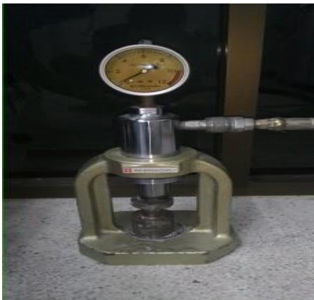
รูปที่ 3.6 นำบล็อกเข้าเครื่องอัดเม็ด
