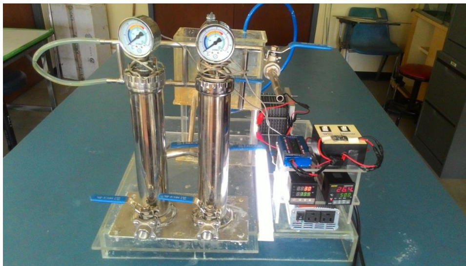
รูปที่ 4.19 แสดงการนำไปใช้งานสำหรับการผลิตก๊าซไฮโดรเจนจากวัสดุผสมอลูมิเนียมกับตัวเร่งปฏิกิริยาท่อนาโนคาร์บอน สำหรับ PEMFC
