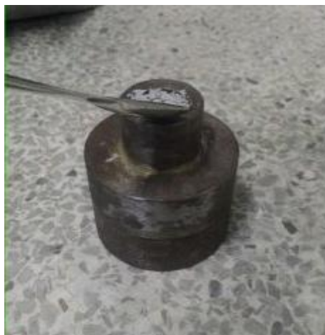
รูปที่ 3.4 นำสาร CNT/Al ใส่บล็อก
