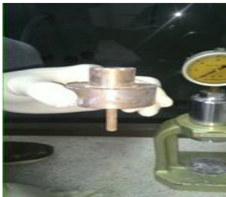
รูปที่ 3.7 นำเม็ดออกจากบล็อก
