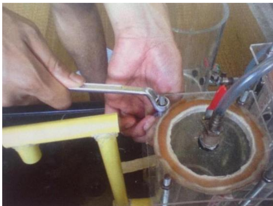
รูปที่ ง-8 หมุนน็อตด้วยประแจเพื่อปิดฝ้ายีตระหว่างฝาปิดกับฐานรอง
