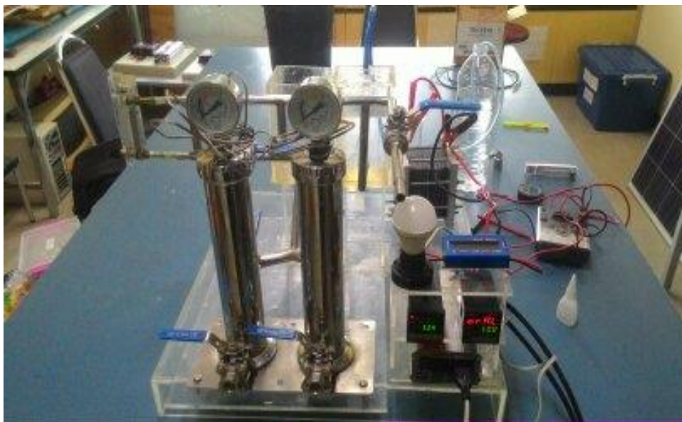
รูปที่ 4.3 ภาพการสร้างเครื่องผลิตก๊าซไฮโดรเจนจากวัสดุผสมอลูมิเนียมกับ ตัวเร่งปฏิกิริยาฟ่อนานาโนคาร์บอน
