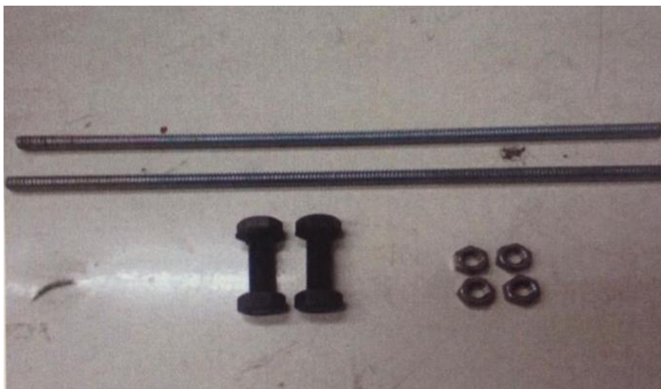
รูปที่ ค-5 เกลียวเส้น เส้นผ่านศูนย์กลางขนาด 5 มิลลิเมตร และน็อต
