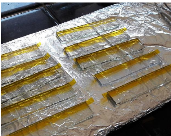
รูปที่ 3.14 แสดงกระจกนำไฟฟ้าที่ติดเทปสำหรับมาร์คกึ่งเพื่อใช้ในการทำเป็นขั้วไฟฟ้า
