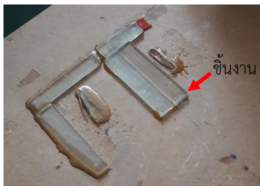
รูปที่ 3.6 แสดงการใส่กระจกนำไฟฟ้าในช่องบล็อกสกรีน (block screen)
