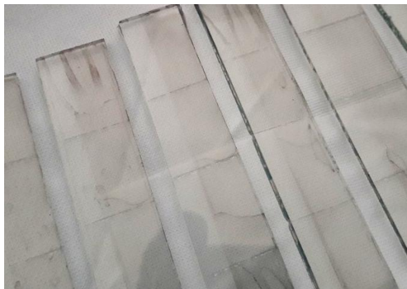
รูปที่ 3.16 แสดงตัวอย่างหลังเผาที่ทำการเคลือบแพลทินัม (Platinum, Pt) ด้วยเทคนิคสปิน
