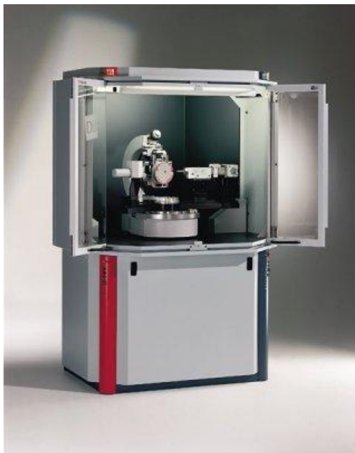
รูปที่ 2.8 เครื่องตรวจวัดการเลี้ยวเบนรังสีเอกซ์ (XRD) ที่มา (ศูนย์เครื่องมือวิจัยวิทยาศาสตร์และเทคโนโลยีจุฬาลงกรณ์, 2555)
