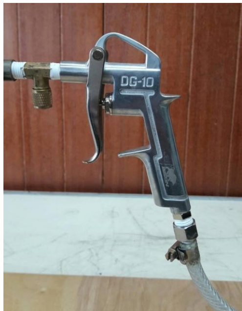
รูปที่ ก. 7 แสดงปืนลมเพื่อใช้กดปล่อยแรงดันแก๊ส
