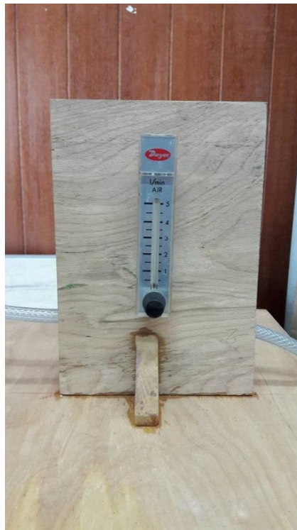
รูปที่ ก. 9 แสดงการติดตั้งตัวควบคุมอัตราการไหล (flow meter)
