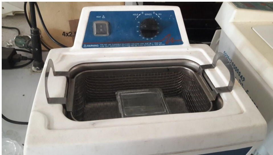
รูปที่ ก. 12 แสดงการล้างกระจกนำไฟฟ้า
