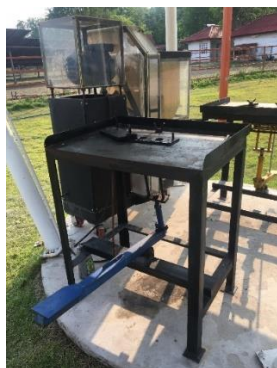
ภาพที่ 3.2 เครื่องอัดเชื้อเพลิง (แบบใช้แรงงานคน)
