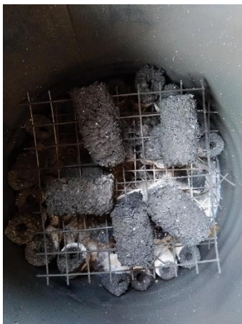
ภาพที่ 3.5 การจัดวางก้อนถ่านเพื่อทำการเผา
