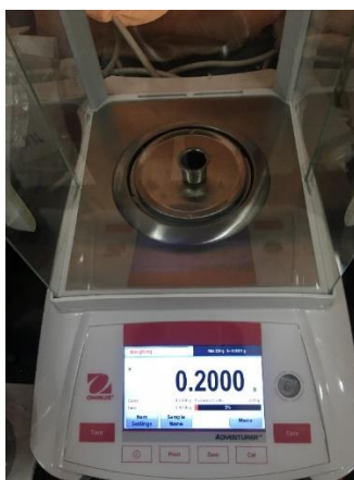
ภาพที่ 3.10 การชั่งน้ำหนักเชื้อเพลิงอัดแท่งในการหาค่าความร้อน
