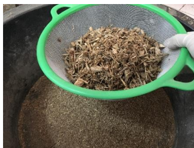
ภาพที่ 3.1 การคัดแยกเหง้ามันสำปะหลังให้มีขนาดเล็กโดยการร่อน
