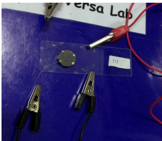
รูปที่ 3.18 เทคนิค Van der Pauw ที่มหาวิทยาลัยขอนแก่น
