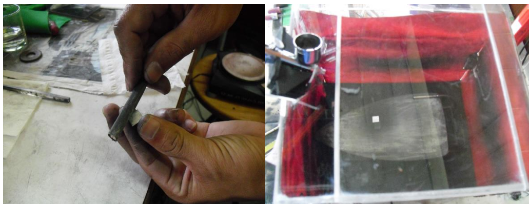
ค-4. แสดงการขัดแผ่นอลูมิเนียม 6061 ด้วยกระดาษทรายแล้วเช็ดผิวให้สะอาดจากนั้นนำไปวางในห้องเคลือบ
