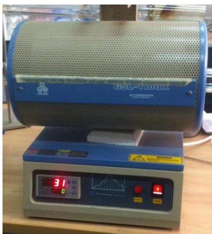
รูปที่ 3.8 CNT/C เตาเผาแบบท่อที่อุณหภูมิ 900 องศาเซลเซียส
