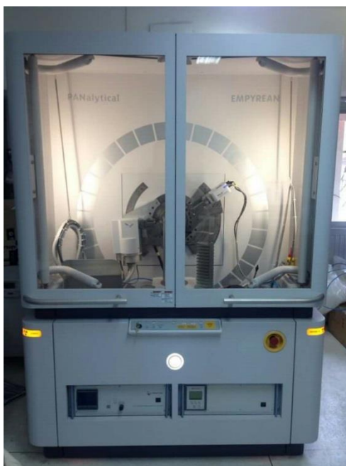
รูปที่ 3.14 เครื่อง X-ray Diffractometer (XRD) ที่มหาวิทยาลัยขอนแก่น
