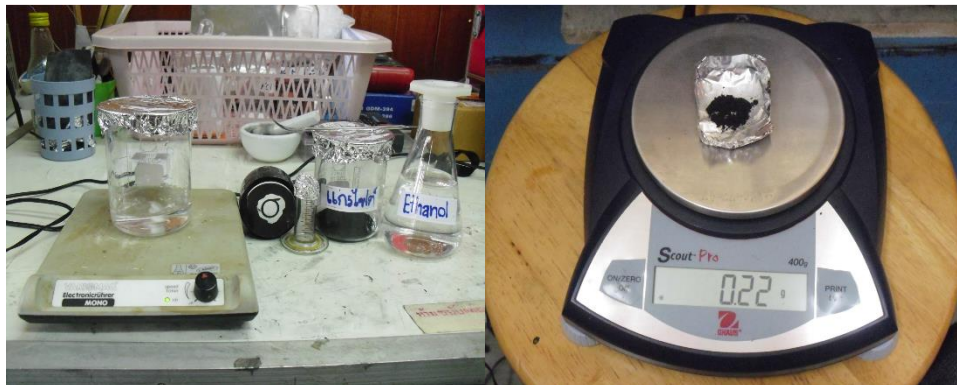
ค-5. แสดงสารที่ใช้ในการเตรียมแกรไฟต์ที่เปอร์เซ็นต์แกรไฟต์ต่างๆและชั่งแกรไฟต์ด้วยเครื่องชั่งดิจิตอลแบบ 3 ตำแหน่ง
