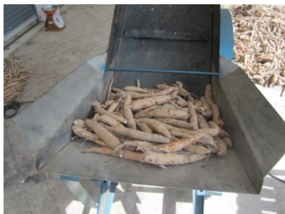
ภาพที่ 3.25 แสดงการนำหัวมันสำปะหลังที่ผ่านการซังเข้าเครื่องสายพานลำเลียง
