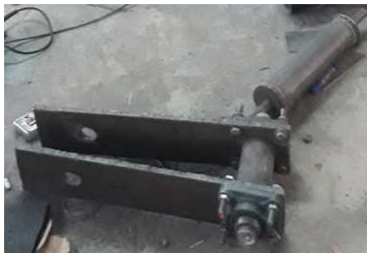
ภาพที่ 3.5 แสดงการประกอบลูกกลิ้งสายพานลำเลียงตัวบนและตัวล่าง
