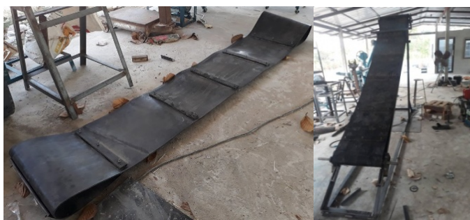
ภาพที่ 3.6 แสดงลักษณะของสายพานลำเลียงที่ประกอบเข้ากับโครงสร้างฐานเครื่อง
