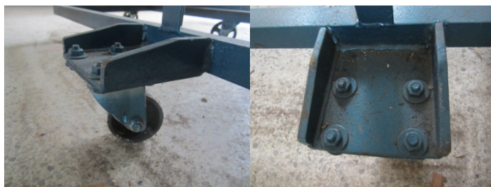
ภาพที่ 3.9 แสดงการประกอบยึดล้อเหล็กเข้ากับโครงสร้างฐานเครื่องสายพานลำเลียง
