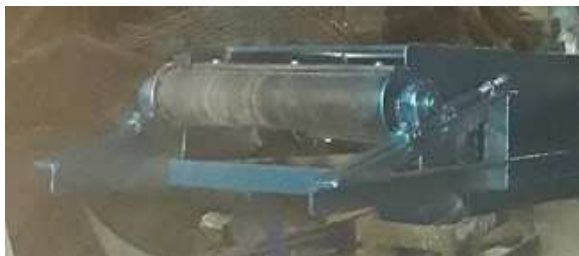
ภาพที่ 3.11 แสดงลักษณะของชุดปรับความตึง-หย่อนของระบบสายพาน
