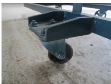
ภาพที่ 3.20 แสดงการติดตั้งล้อเหล็กที่โครงสร้างฐานของเครื่องสับ
