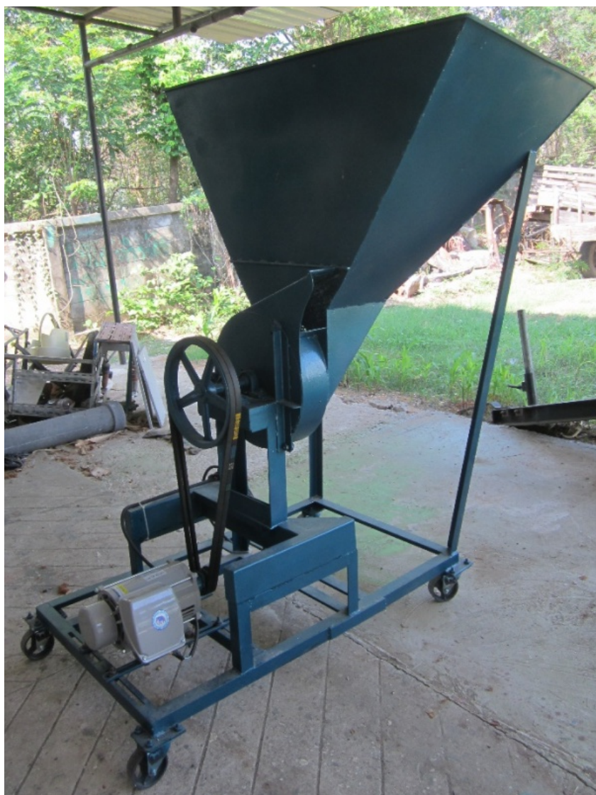
ภาพที่ 3.22 แสดงรูปร่างลักษณะของเครื่องสับหั่วมันสำปะหลังต้นแบบที่พัฒนาสร้างขึ้น
