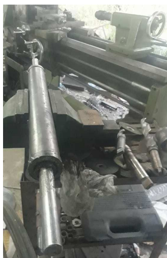
ภาพที่ 3.4 แสดงลักษณะลูกกลิ้งสายพานลำเลียงที่ผ่านการกลึง
