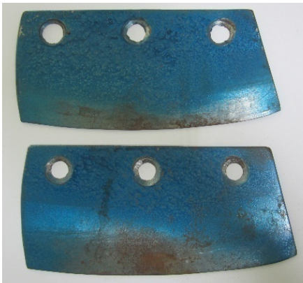
ภาพที่ 3.17 แสดงลักษณะใบมีดของเครื่องสับหัวมันสำปะหลัง
