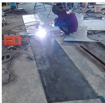
ภาพที่ 3.7 แสดงลักษณะการตัดโลหะแผ่นให้ได้ตามแบบ
