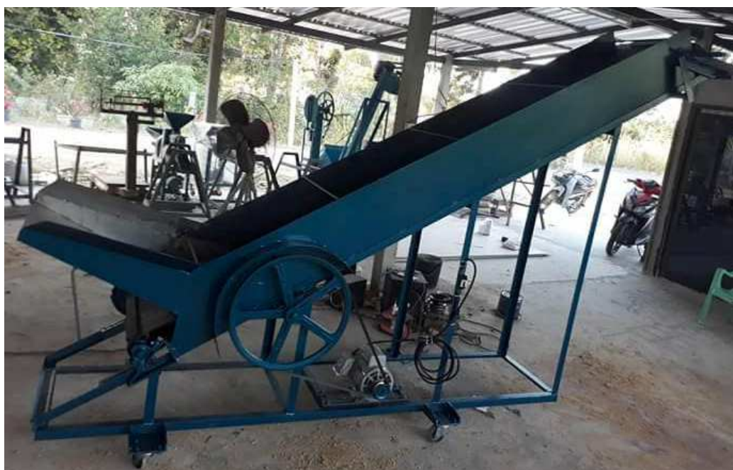
ภาพที่ 3.15 แสดงเครื่องชุดสายพานลำเลียงหุ้มมันสำปะหลังต้นแบบที่พัฒนาสร้างขึ้น
