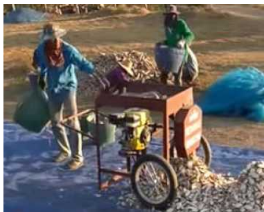
ภาพที่ 1.1 แสดงเครื่องสับหัวมันสำปะหลังที่ป้อนด้วยมือ
