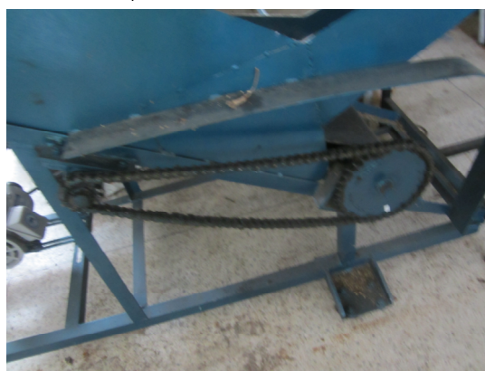
ภาพที่ 3.10 แสดงลักษณะระบบส่งกำลังและเพลาชับสายพานลำเลียง
