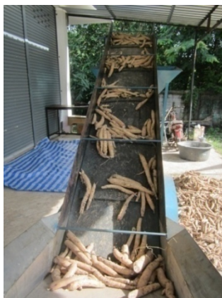
ภาพที่ 3.26 แสดงเครื่องสายพานลำเลียงหัวมันสำปะหลังเข้าเครื่องสับ
