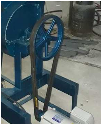
ภาพที่ 3.19 แสดงการติดตั้งประกอบพูลเลย์ยึดกับเพล
