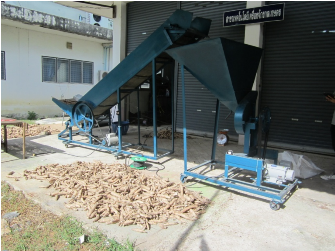
ภาพที่ 3.23 แสดงการเตรียมอุปกรณ์เครื่องสับหัวมันสำปะหลังที่พร้อมทดสอบ
