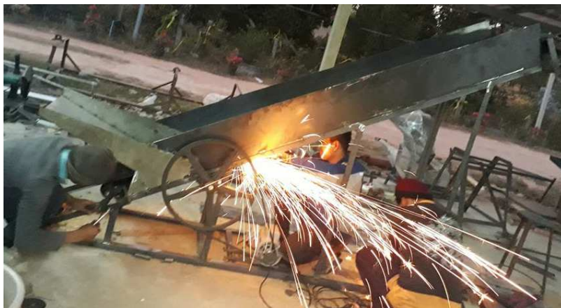
ภาพที่ 3.8 แสดงการยึดกะบะถังบรรจุหัวมันสำปะหลัง
