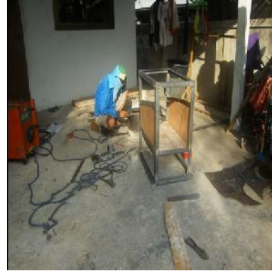
ภาพที่ ก.2 โครงสร้างของเครื่องตัดแยกเมล็ดพันธุ์
