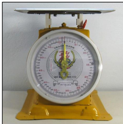
ภาพที่ 3.8 เครื่องชั่งน้ำหนักมีความละเอียดในการชั่ง 0.01 กิโลกรัม ชั่งได้สูงสุด 10 กิโลกรัม
