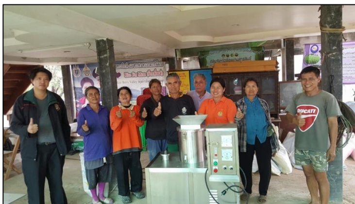
ภาพที่ 3.6 เครื่องบดข้าวแบบตะแกรงร่อนคัดแยกขนาดอัตโนมัติที่เสร็จสมบูรณ์
