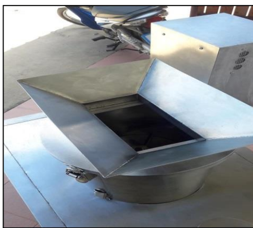
ภาพที่ 3.4 ช่องทางใส่ข้าวสีเหลี่ยม (Square hopper)
