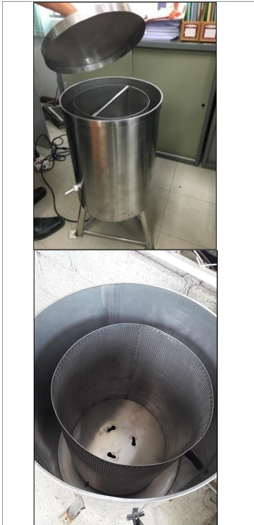
ภาพที่ ข-2.1 นวัตกรรมเครื่องสกัดน้ำมันออกจากข้าวแต๋น
