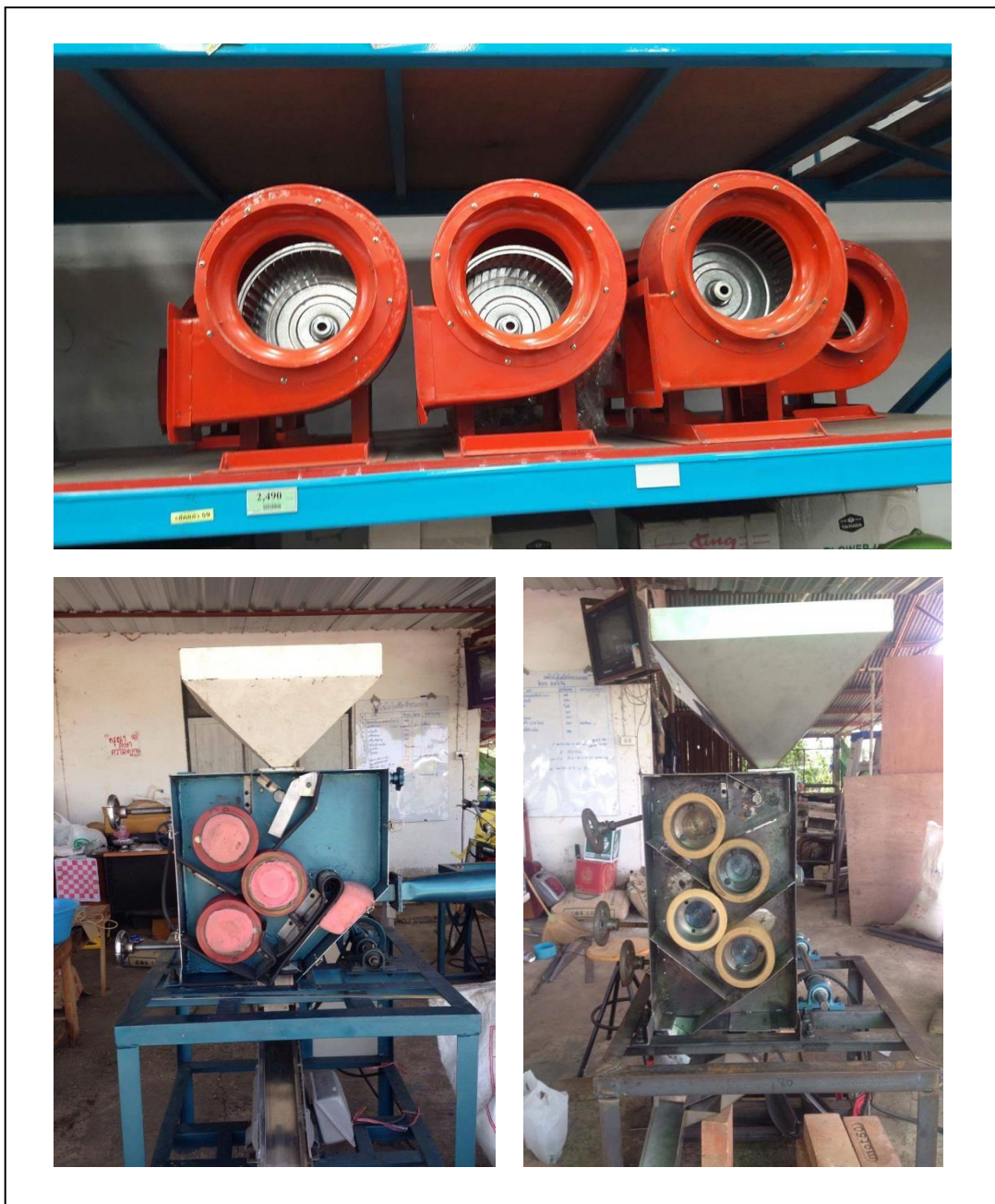
การประกอบเครื่องสีข้าวแบบ 4 ลูกกลิ้ง แยกรำด้วยระบบไซโคลน
