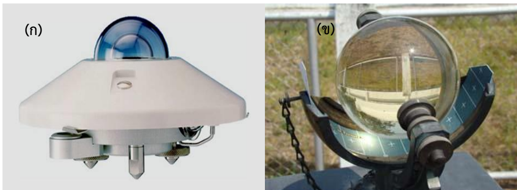
รูปที่ 2.18 (ก) ไพรานอมิเตอร์ (ข) เครื่องบันทึกแดดแบบลูกแก้ว ที่มา : http://www3.egat.co.th/re/solarcell/solarcell.htm
