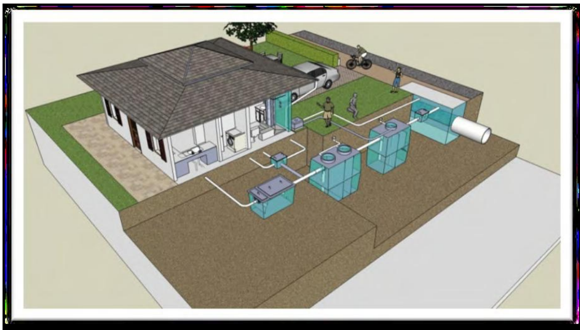
ภาพที่ 2.35 รูปแบบระบบบำบัดน้ำเสียแบบติดกับที่ ที่มา: สำนักจัดการคุณภาพน้ำ กรมควบคุมมลพิษ, 2559
