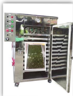
นำซาที่ได้อบแห้งด้วยเครื่อง Tray dryer ที่ระดับอุณหภูมิ 60,70 และ 80 องศาเซลเซียส
