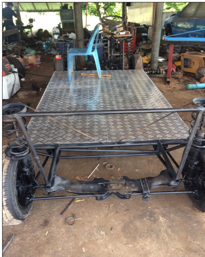
ภาพการประกอบตัวถังรถไฟฟ้าคันที่ 1
