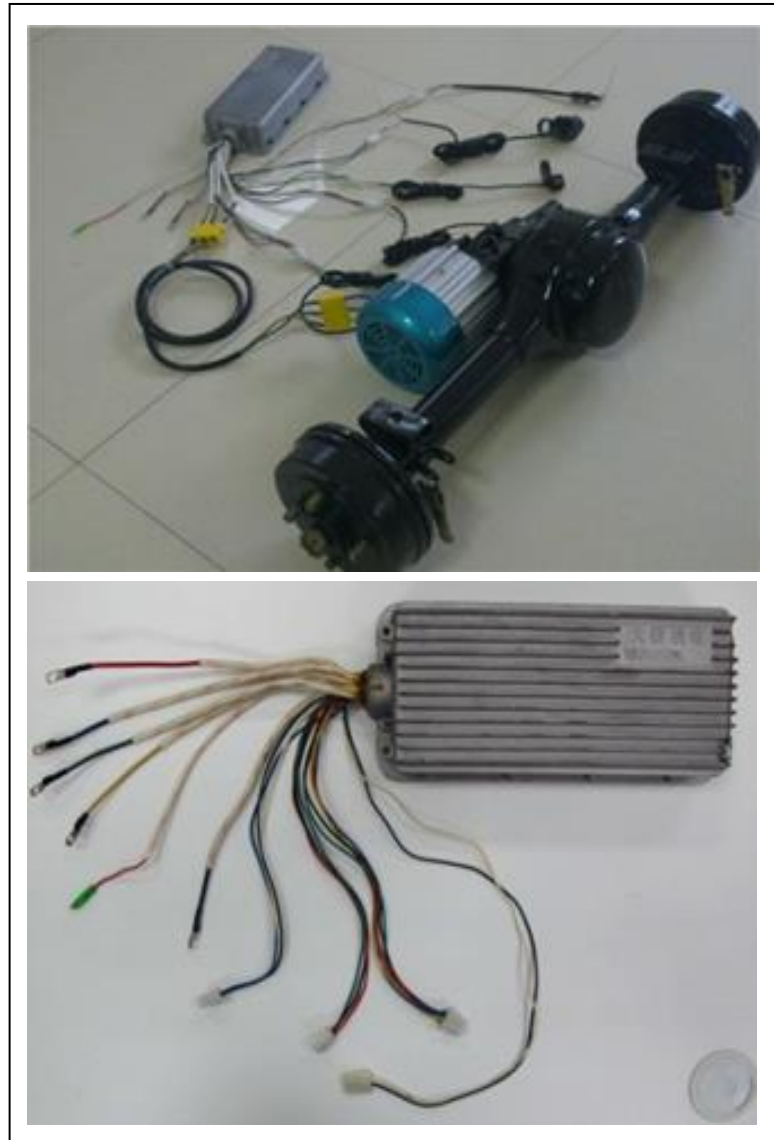
ภาพที่ 4.10 ชุดควบคุมและชุดมอเตอร์
