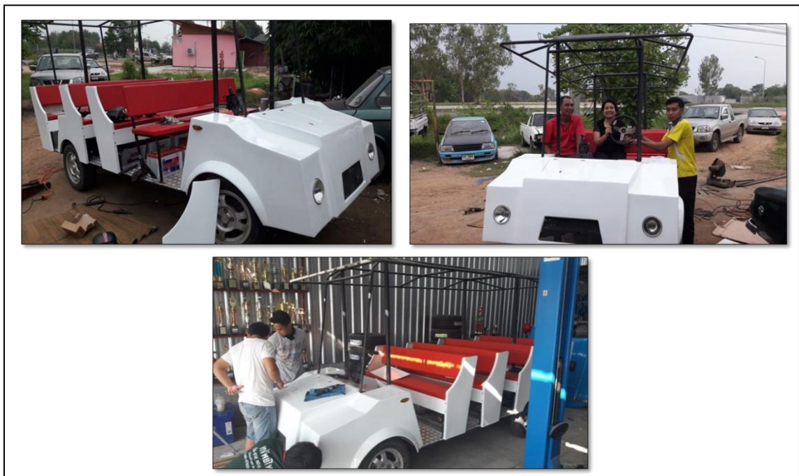
ภาพที่ 3.9 การประกอบรถพลังงานไฟฟ้าให้สมบูรณ์ RMU- Shuttle EV คันที่ 1
