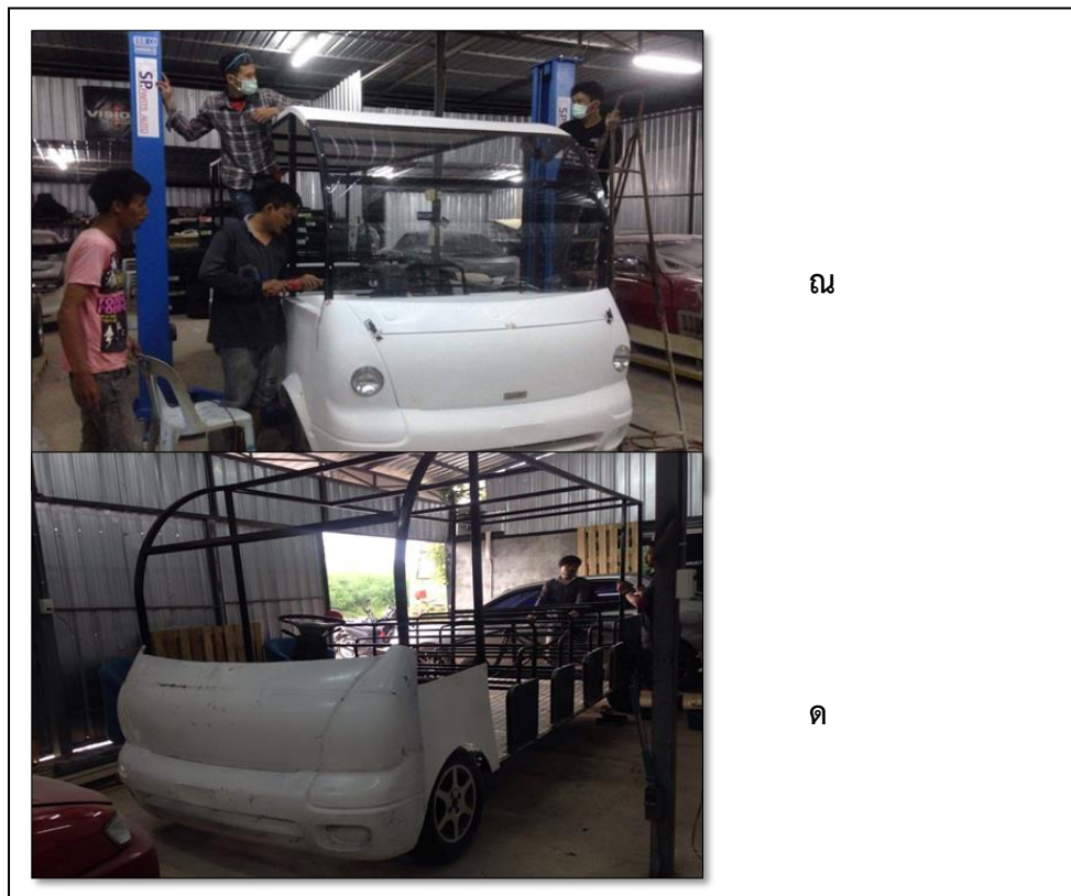
ภาพที่ 3.14 ประกอบโครงสร้างภายนอกรถไฟฟ้า คันที่ 2
