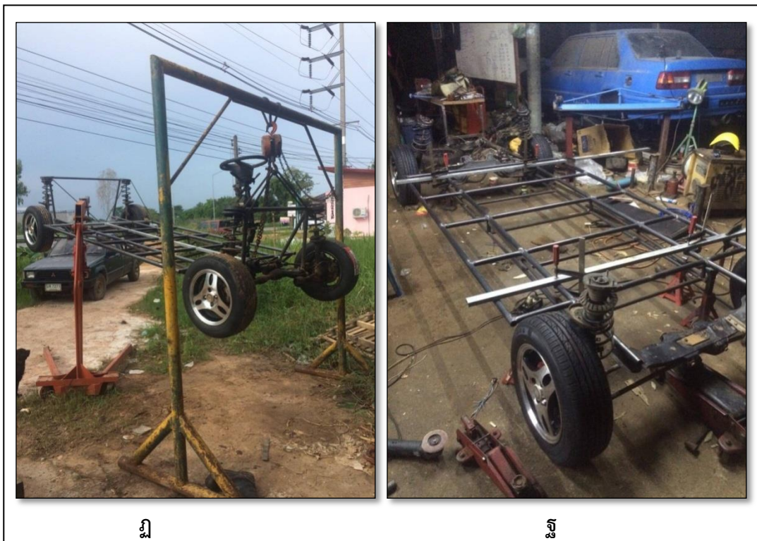
ภาพที่ 3.13 โครงสร้างรถไฟฟ้า คันที่ 2
