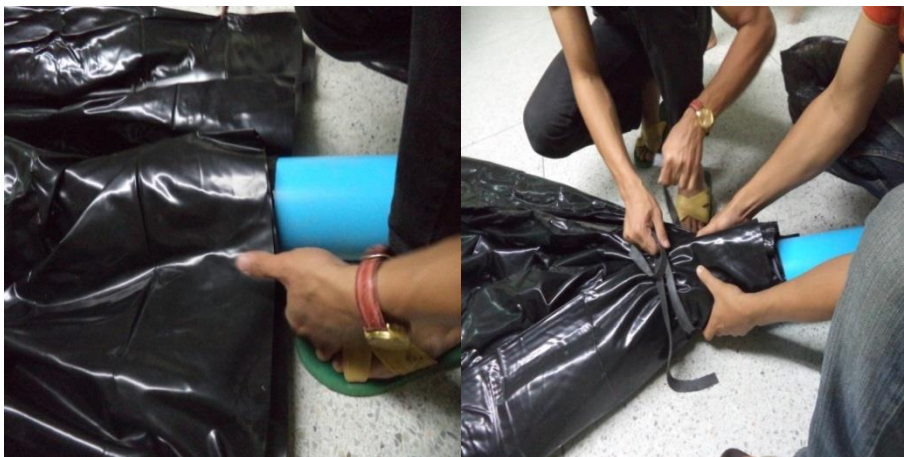
รูปที่ 3.20 มัดประกอบถุงหมักแอลดีพีอีเข้ากับท่อพีวีซี
