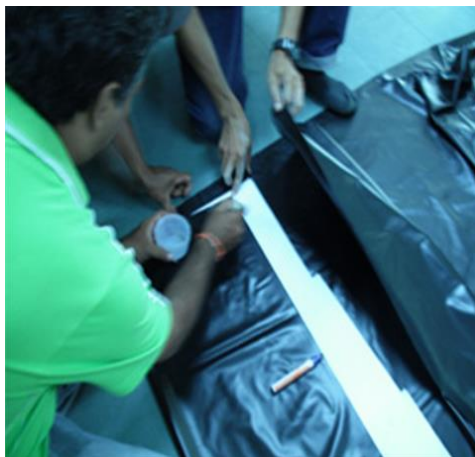
รูปที่ 3.18 ทากาวเพื่อประกอบถุงหมักแอลดีฟ็อกซ์
