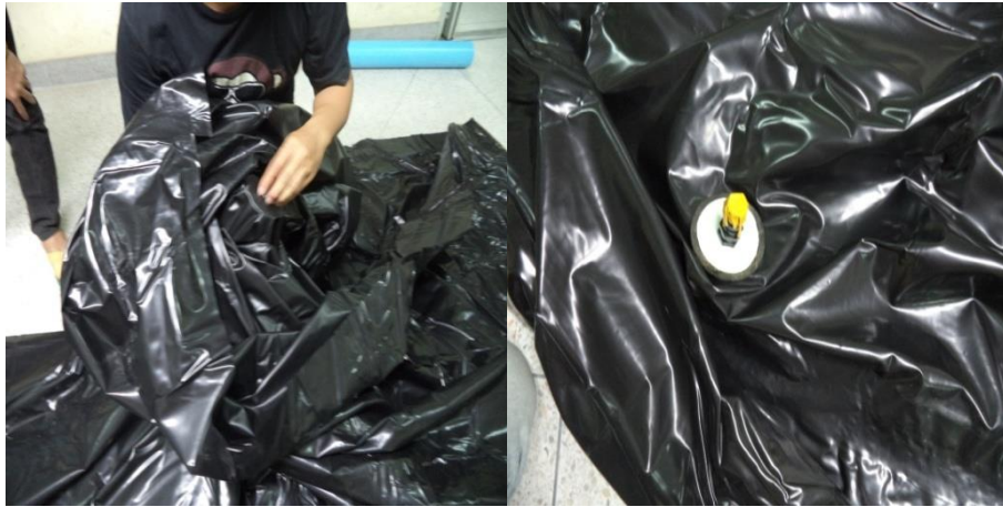
รูปที่ 3.19 ติดตั้งชุดส่งก๊าซ
