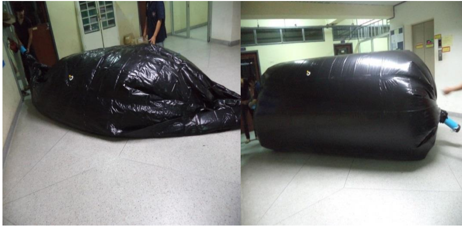
รูปที่ 3.21 เป่าลมทดสอบบรอยรั่ว ชั้นที่ 6 นำถุงไปยังหลุมที่เตรียมไว้จัดวางถุงให้ดี ต่อสายยางเข้ากับชุดส่งก๊าซที่ ถุง แล้วเติมน้ำให้ท่วมปลายท่อด้านในของถุงทั้งสองด้าน แกะพลาสติกที่มีดปลายท่อพีวีซีทั้งสองด้านออกดัง รูปที่ 3.22
