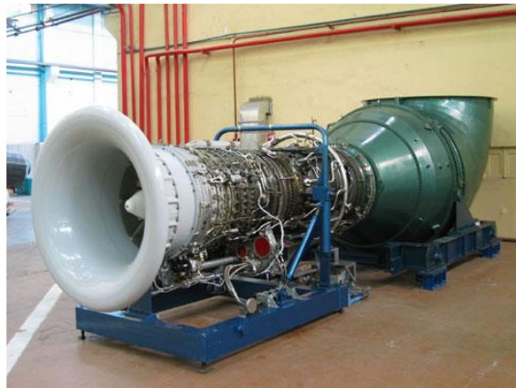
รูปที่ 2.22 กังหันก๊าซผลิตไฟฟ้า
