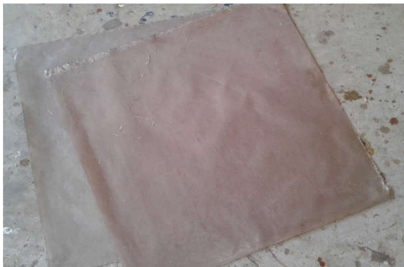
รูปที่ ค-13 ผ้าใยแก้วเคลือบเทฟลอน (Teflon Glass Fiber)
