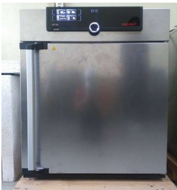
รูปที่ ค-8 ตู้อบความร้อน MEMMERT Universal Oven รุ่น UN110
