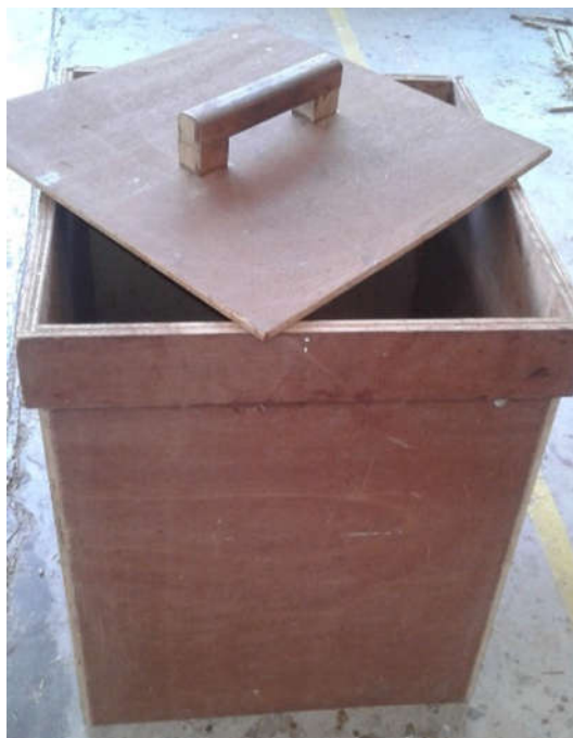
รูปที่ ค-15 แม่พิมพ์โรยแผ่น พื้นที่หน้าตัด 450×450 mm
