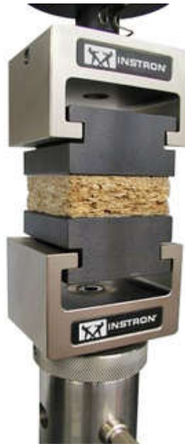
รูปที่ 2.17 การวัดความต้านแรงดึงตั้งฉากกับผิวหน้า
