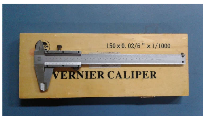
รูปที่ ค-1 เวอร์เนีย Vernier Caliper ความละเอียด 0.02 mm
