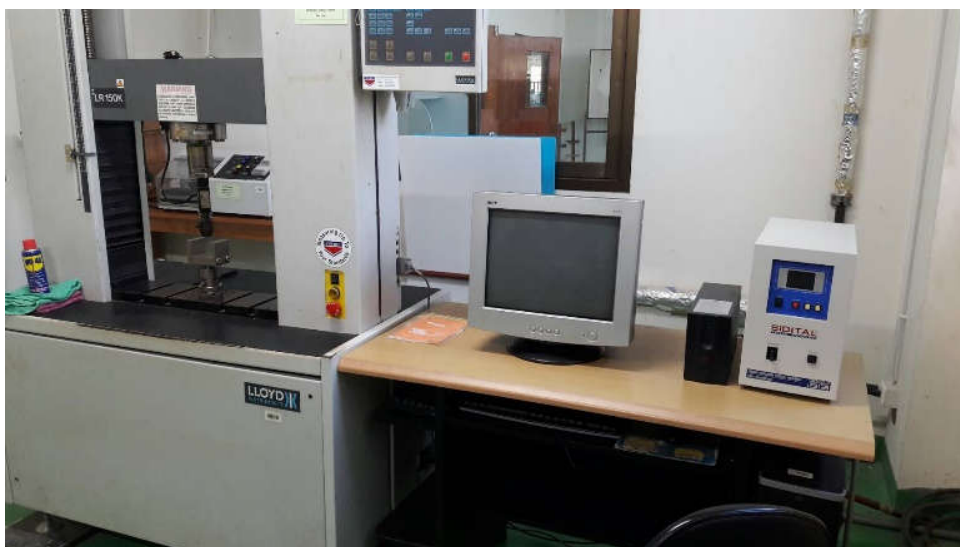
รูปที่ ค-10 เครื่องทดสอบแรงดึง (Universal Test Machines - Up to 150 kN)
