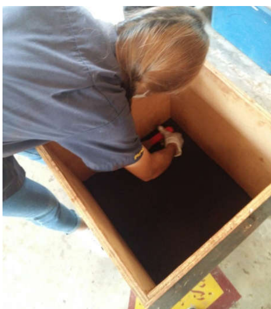
รูปที่ ค-20 ขั้นตอนการโรยวัสดุลงในแม่พิมพ์
