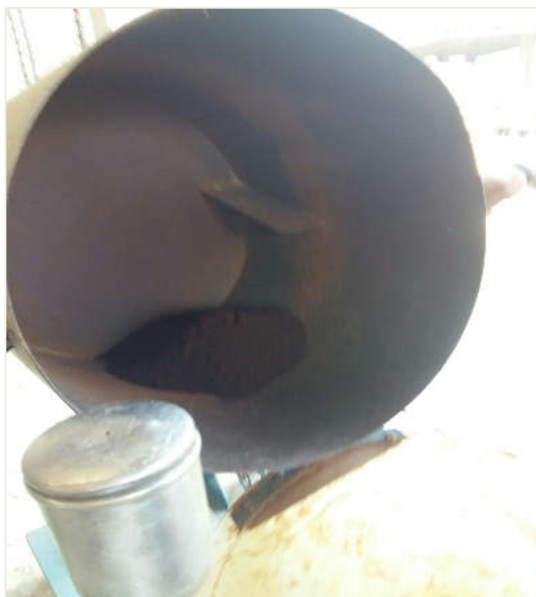
รูปที่ ค-19 การผสมกากกาแฟคั่วบดกับกับกาวไอโซไซยานต
