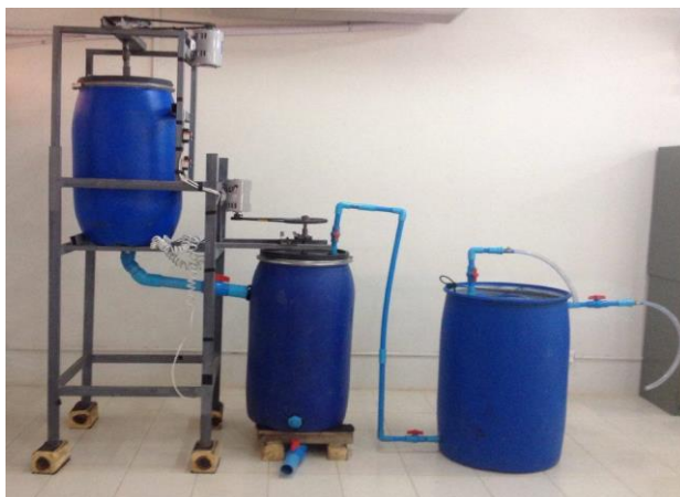
ภาพที่ 3.8 ภาพชุดถังหมักก๊าซชีวภาพแบบสองชั้นตอนที่ใช้ในการทดลอง
